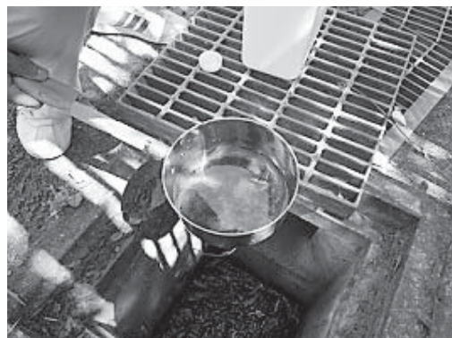
写真IV-1 柄杓による幼虫の生息調査 （雨水ます）
